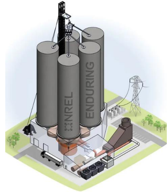
Piaskowy zasobnik ciepła zintegrowany z układem energetycznym
