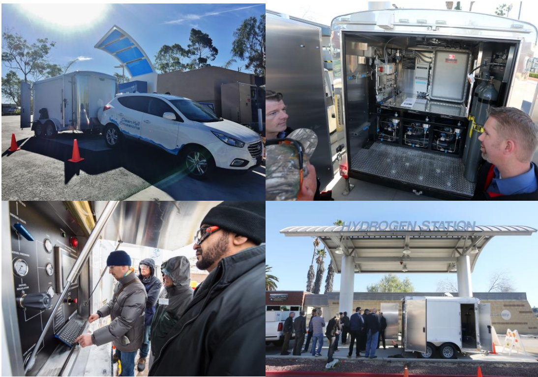
Rysunek 11. (po lewej). Opracowanie raportu dotyczącego sprawności wyposażenia stacji wodorowych (HyStEP). Źródła: https://www.osti.gov/servlets/purl/1481500 i https://h2tools.org/hystep-hydrogen-station-equipment-performance-device
